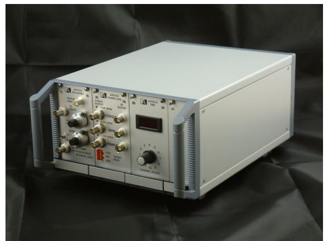
データ解読/表示機器 (デモデューレーター、デコーダー、パワー算出器、 デジタル表示器等を含む)
