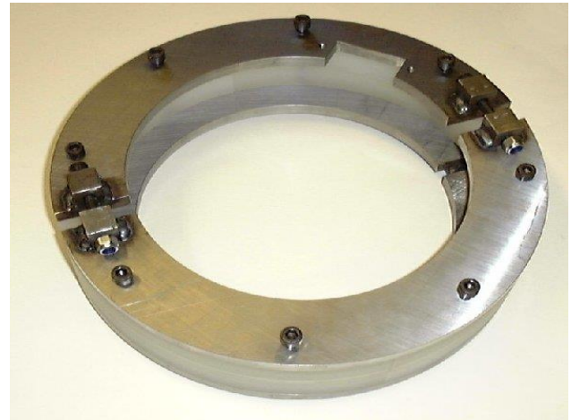
ステンレス スチール製 分割リング アッセンブリー (トルクデータ送信器、誘導電源受信ループ などを内蔵)
