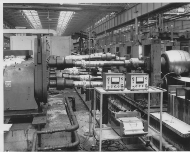
最初のテレメトリー採用システム(1970年代) (7対の回転駆動シャフトトルクモニター、 バッテリーパワー送信器を使用)
