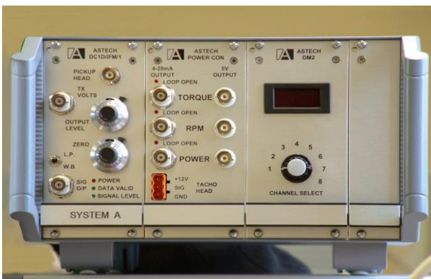
データ処理用エレクトロニクス (デモデューレーター、出力機器、表示機器を含む)
