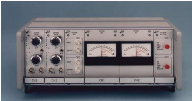
データ処理用エレクトロニクス (デモデューレーター、表示機器を含む)
